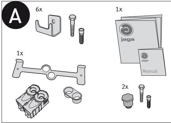
Neem het ophangjabloon, de onderdelen voor de muurbevestiging en de aansluiting uit de verpakking.
