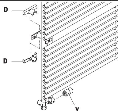
**17 Thermostatkopf (Y) an das Winkeleckventil schrauben und Abdeckung (D) für Abstandhalter montieren.**
