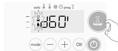
Urządzenie wyłącza się, ale tryb pracy intensywnej jest cały czas aktywny: na wyświetlaczu cały czas widać licznik, a symbol pracy intensywnej i kontrolka ogrzewania migają. Gdy temperatura spadnie poniżej maksymalnej dopuszczalnej temperatury, urządzenie zostanie uruchomione ponownie i będzie pracować do zakończenia odliczania.
