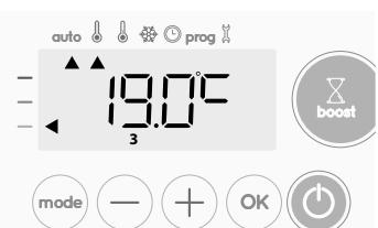
rang vor allen anderen empfangenen Befehlen, außer wenn der Befehl Standby (Stopp) von der Steuerleitung vorliegt. In diesem Fall schaltet sich das Gerät ab und der Boostbetrieb wird nicht aktiviert.
