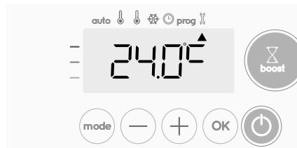
Vähennä ympäristön lämpötilaa mittaavan anturin lämpötilaa 2°C painamalla
