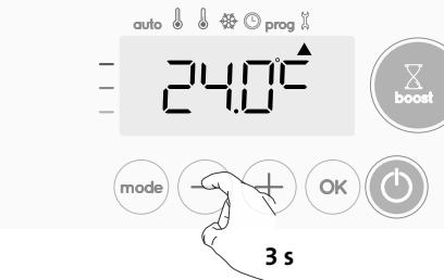
2- Pour enregistrer et passer automatiquement au réglage suivant, appuyez sur (OK). Pour quitter les paramètres expert, appuyez 3 fois sur (mode).
