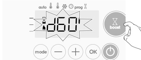
Durant la première minute, vous pouvez modifier la durée du Boost de 0 à la durée maximale autorisée du Boost, telle que définie lors de la configuration avancée (voir page 13 pour plus de détails) par incrément de 5 minutes (ou plus rapidement par pression de plus de 2 secondes) en appuyant sur et .
