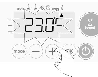
Um die Einstellung zu validieren, den neuen Wert zu speichern und den Modus zu verlassen, drücken Sie **OK**. Um die Experteneinstellungen zu verlassen, drücken Sie drei Mal **mode**.
