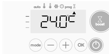
Diminuez de 2 °C la température mesurée par la sonde de température ambiante en appuyant sur (−).
