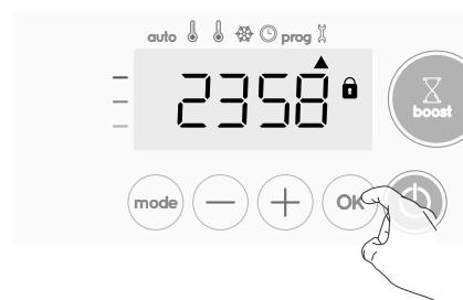
4- Druk nogmaals op **OK** om de modus voor het instellen van de PIN-code af te sluiten en terug te keren naar het startscherm van de installatieinstellingen.
