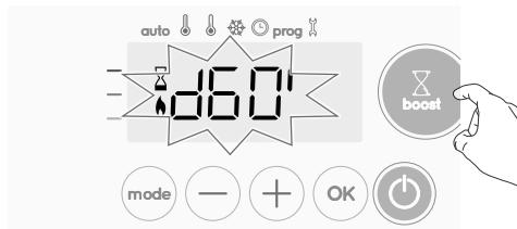
In der ersten Minute können Sie die Dauer des Boostbetriebs von 0 auf die maximal zulässige Dauer des Boostbetriebs erhöhen, wie in den erweiterten Einstellungen definiert (weitere Einzelheiten siehe Seite 13). Die Einstellung erfolgt in Intervallen von 5 Minuten (zum schnelleren Umschalten, die Taste mindestens 2 Sekunden gedrückt halten) durch Drücken von und . Diese Änderung wird gespeichert und mit dem nächsten Boost wirksam.
