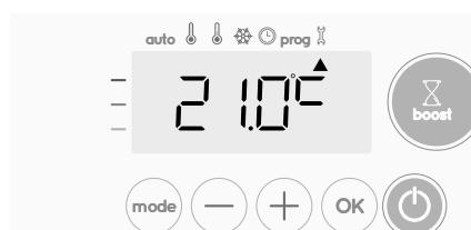
Augmentez de 2 °C la température mesurée par la sonde température ambiante en appuyant sur (+).
