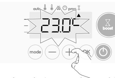
**Om te valideren, slaat u de nieuwe waarde op en sluit u de modus af door te drukken op **OK**. Om de Expert-instellingen te verlaten, drukt u 3 maal op **mode**.**
