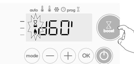
Het apparaat schakelt uit maar de Boost-modus blijft nog steeds actief: de telling wordt altijd weergegeven, het Boost-symbool en het verwarmingslampje knipperen op het scherm. Wanneer de temperatuur onder de maximaal toegestane temperatuur duikt, zal Boost opnieuw gestart worden totdat de teller eindigt.
